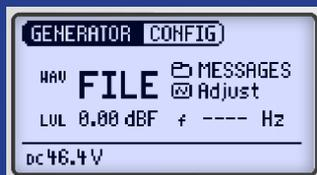
MR-PRO は工場出荷時にさまざまなテストファイル、例えば音声明瞭度測定用信号がストアされています。ユーザーは独自のテスト信号を追加でストアできます。
