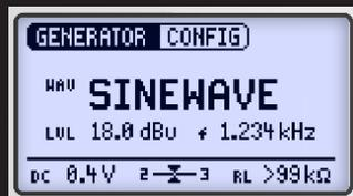
Minirator は、ユーザーが設定する周波数、増幅度でサイン波を出力します。設定可能な周波数間隔は、最小で 0.1Hz です。
